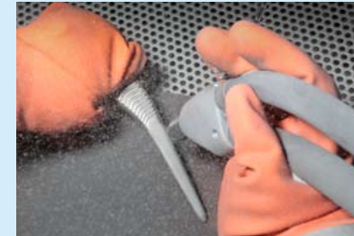
Die Oberfläche wird beim Strahlen aufgeraut
